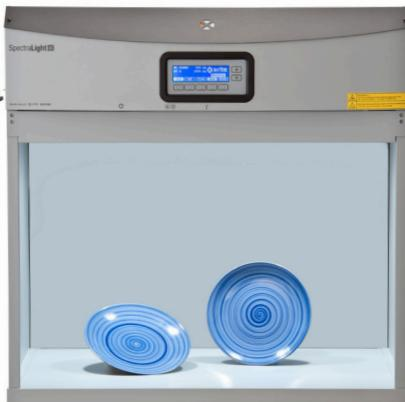
SpectraLight QC 所採用的照明技術優於市場上的任何光源箱。由於本儀器具有的光源數量較多 — 包括日光、白熾光「A」、水平日光、三種熒光 (CWF、U30、U35、TL83 和 TL84 之間的任何組合) 和 UVa，數量超過任何其他產品，因而可以應用於任何規格。集成光傳感器提供熒光燈照度的實時數字輸出，並可以通過操作員設置以滿足行業標準，如 ASTM 和 AATCC。儀器的閉環熒光燈控制使得操作員可以從一個光源移動到下一個光源，而無需等待需要的預熱時間。相同的傳感器和電子產品，確保實時控制所有的熒光燈，保持燈泡整個使用期間的精確照度。SpectraLight QC 還提供出廠校準的紫外線，使用戶能夠根據樣品需求（基於應用）調整紫外線量。
